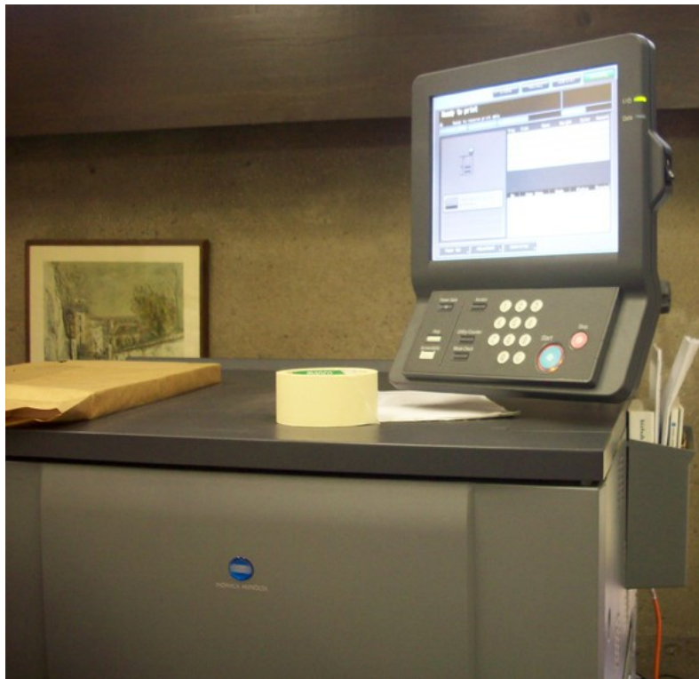
Panneau de commande et écran de l'ordinateur situés sur le dessus de l'imprimante laser pour l'impression des pages intérieures du livre
